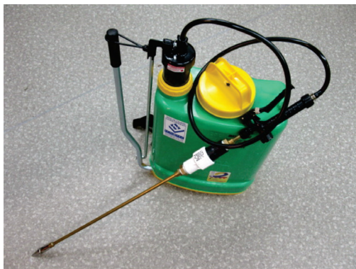
Figura 3. Lanza inyectora. Prototipo diseñado para el chuntaqueo en el cultivo de papa en Colombia.
