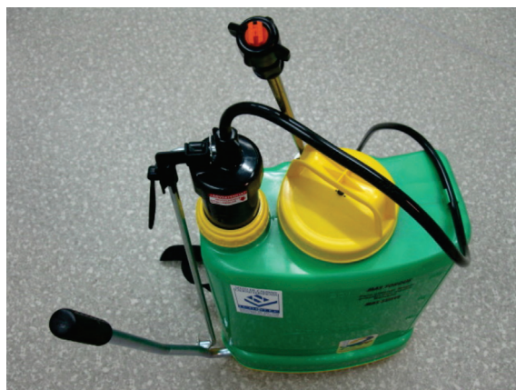
Figura 1. Bomba pulverizadora Lhaura Vet® de pistón sumergido, usado en el chuntaqueo del cultivo de papa en Colombia. (Foto: R. Villalobos R.).
