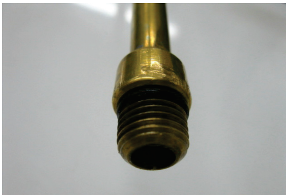
Figura 2. Lanza de la pulverizadora, sin boquilla, exhibiendo el racor roscado. Comúnmente usado en chuntaqueo del cultivo de papa en Colombia. (Foto: R. Villalobos R.).
