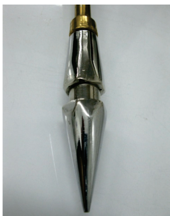
Figura 4. Punta de la lanza inyectora para el uso potencial en el chuntaqueo del cultivo de papa. (Foto: R. Villalobos R.).
