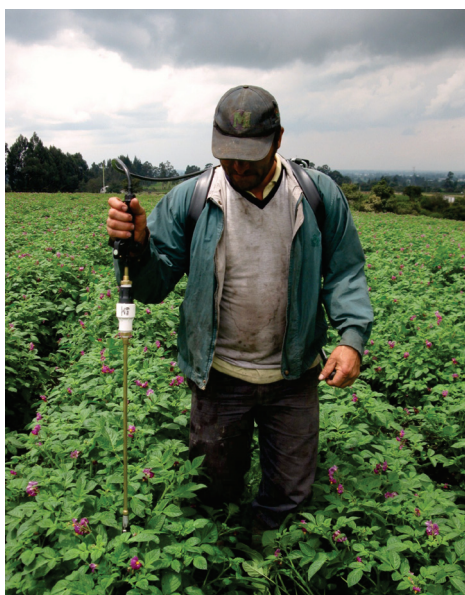
Figura 9. Prototipo del equipo lanza inyectora en un cultivo de papa. (Foto: R. Villalobos R.).
