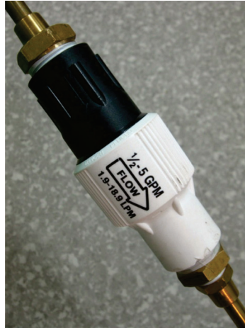
Figura 6. Regulador de presión Senninger® de bajo caudal, usado en la lanza inyectora para el chuntaqueo del cultivo de papa. (Foto: R. Villalobos R.).
