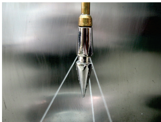
Figura 5. Punta de la lanza inyectora con tres microchorros. (Foto: R. Villalobos R.).
